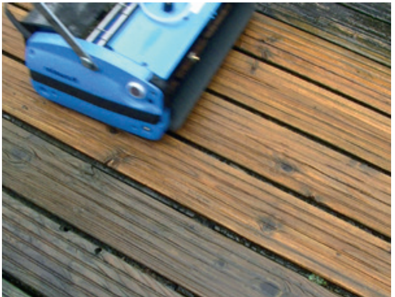
Holzdielen lassen sich sehr gut beispielsweise mit einer Bodenreinigungsmaschine wie Rotowash säubern. Durch die gegenläufigen Zylinderbürsten erfolgt eine gründliche mechanische Reinigung.
