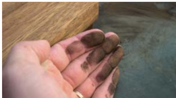
Die austretenden Holzinhaltstoffe sind bei einigen Holzarten dunkel pigmentiert, was zur ungewollten Fleckenbildung führen kann.
